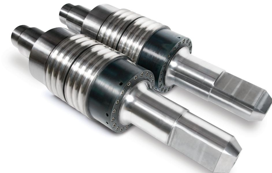
Для сложных условий эксплуатации требуются валки с наилучшими характеристиками. Твердосплавные композитные валки Hyperion предназначены для круглого, квадратного и шестигранного проката, плоской ленты, арматуры, уголков и труб. При этом их стойкость больше, чем у обычных чугунных валков почти в 20 раз.
